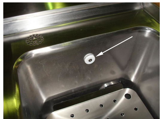
Bild 3: Fühler der Wasserstandsregulierung
