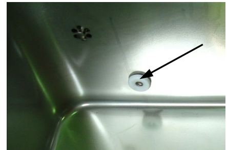
Bild 3: Fühler der Wasserstandsregulierung
